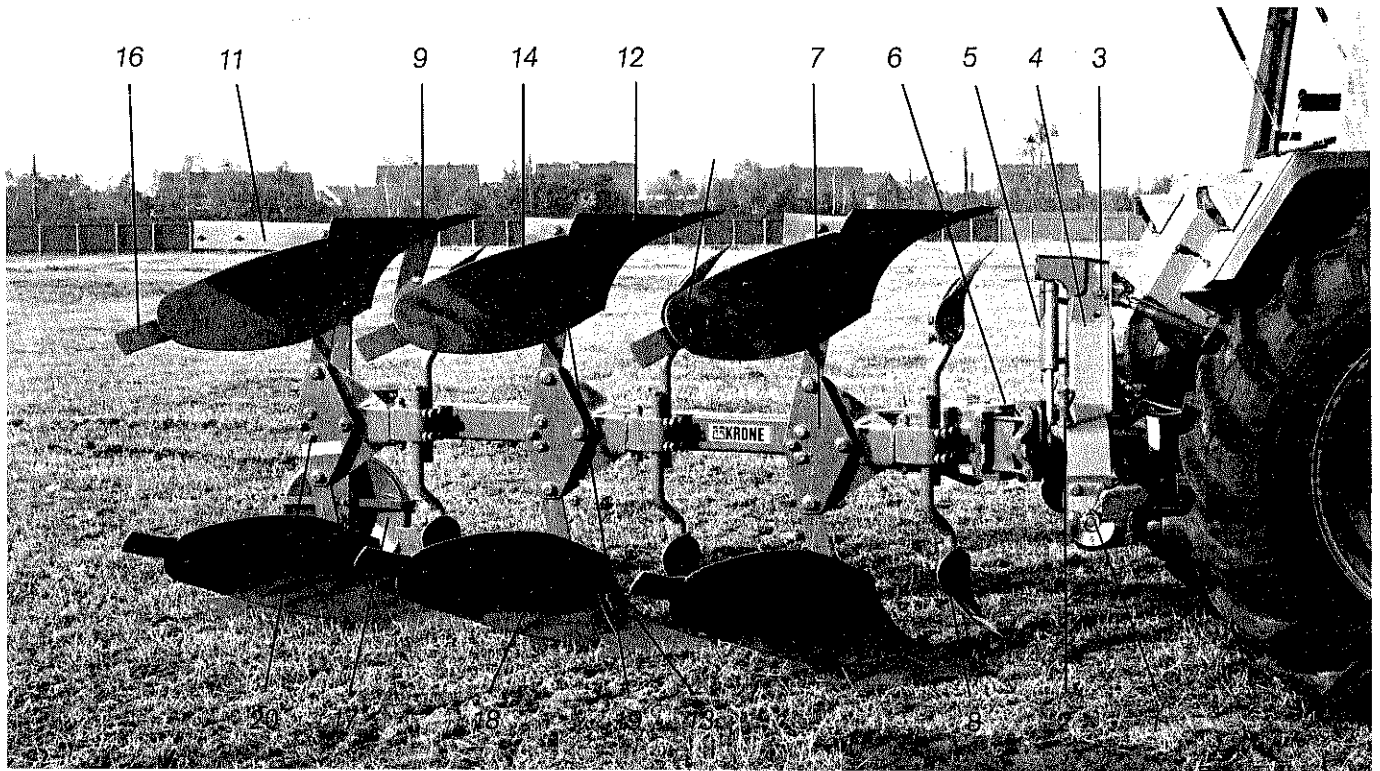
Mustang 120/3 Anbringung von Scheibensechen am 2. und 3. Körper möglich.
